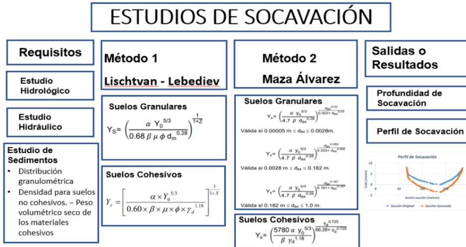
Figura 7. Componentes de estudios de socavación
