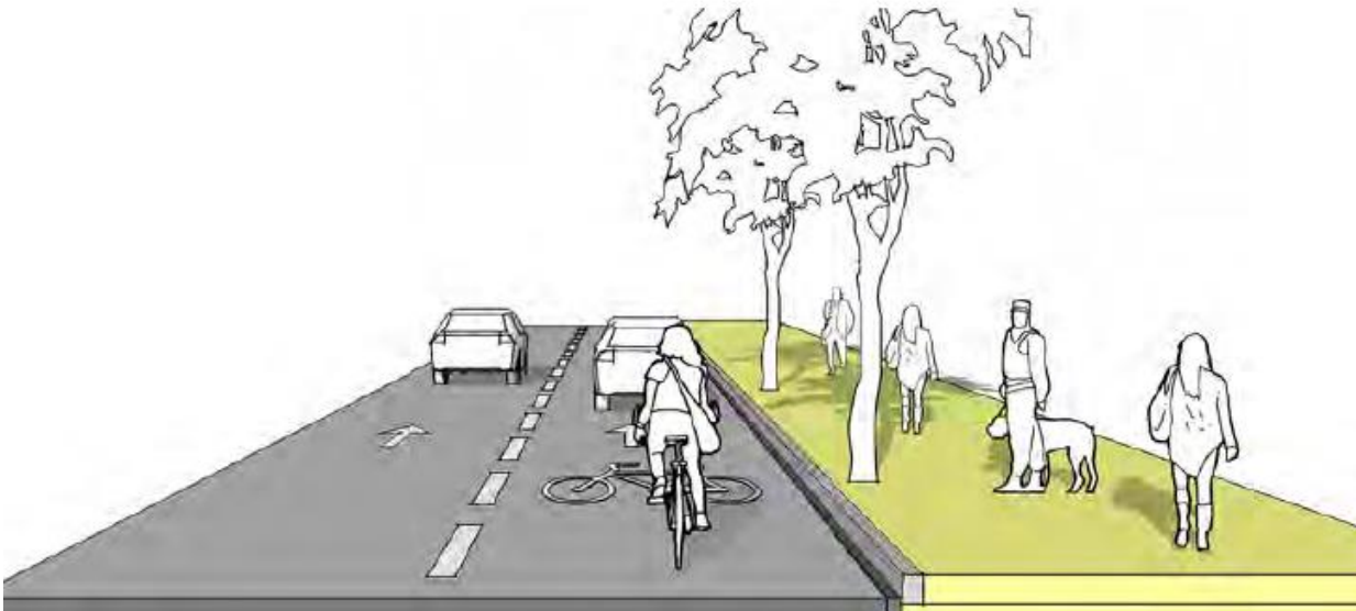
Ilustración 11 Carril ciclopreferente (Fuente: Guía de Ciclo-infraestructura para ciudades colombianas)
