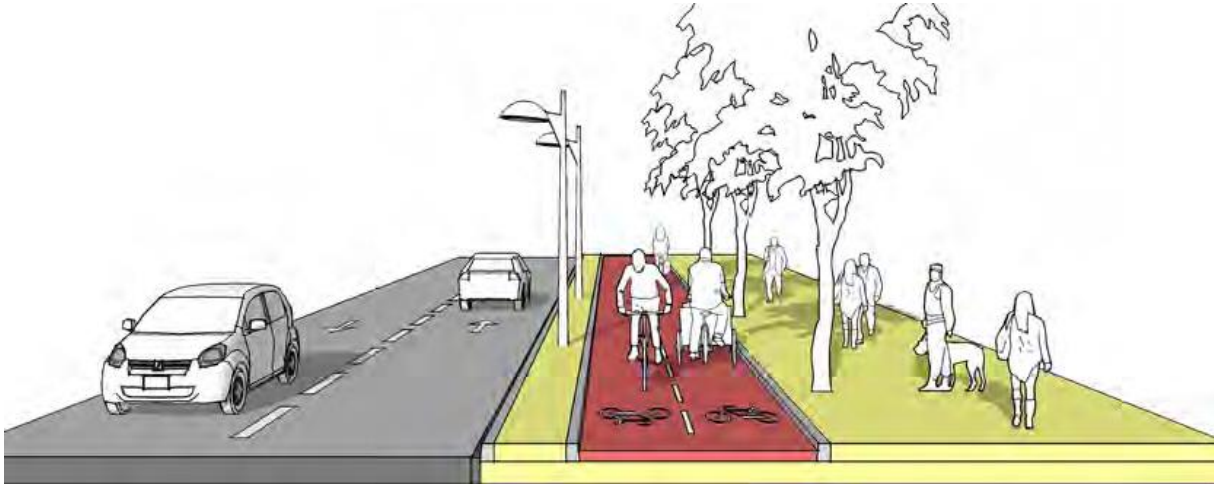
Ilustración 9 Banda ciclorruta (Fuente Guía de Ciclo-infraestructura para ciudades colombianas)
