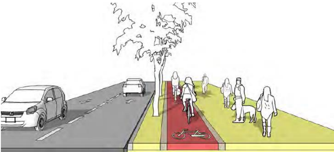
Ilustración 7 Ciclobanda unidireccional sobre andén (Fuente: Guía de Ciclo-infraestructura para ciudades colombianas)
