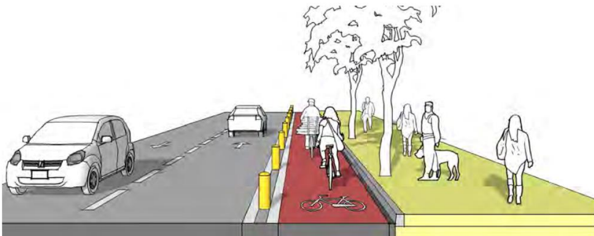
Ilustración 8 Banda ciclorruta (Fuente Guía de Ciclo-infraestructura para ciudades colombianas)
