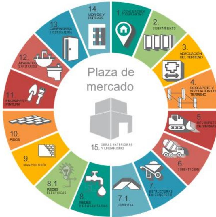
Ilustración 11. Proceso constructivo. Fuente: Grupo de Estructuración de Proyectos.
