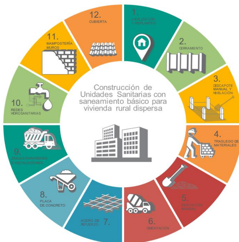
Ilustración 8. Proceso constructivo Unidad Sanitaria (Fuente DNP)
