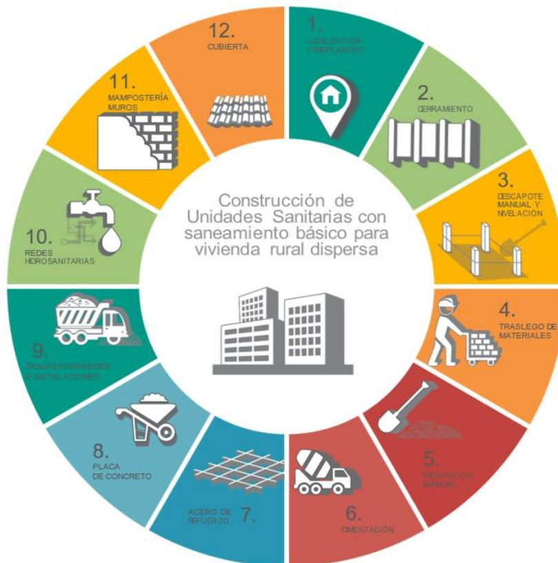
Ilustración 8. Proceso constructivo Unidad Sanitaria (Fuente DNP)
