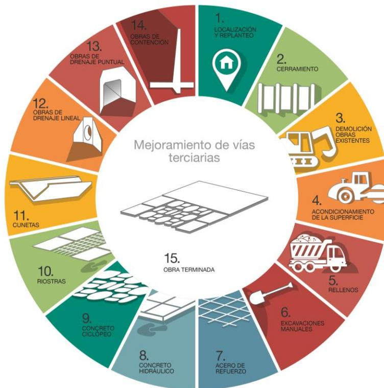
Ilustración 21. Proceso constructivo
